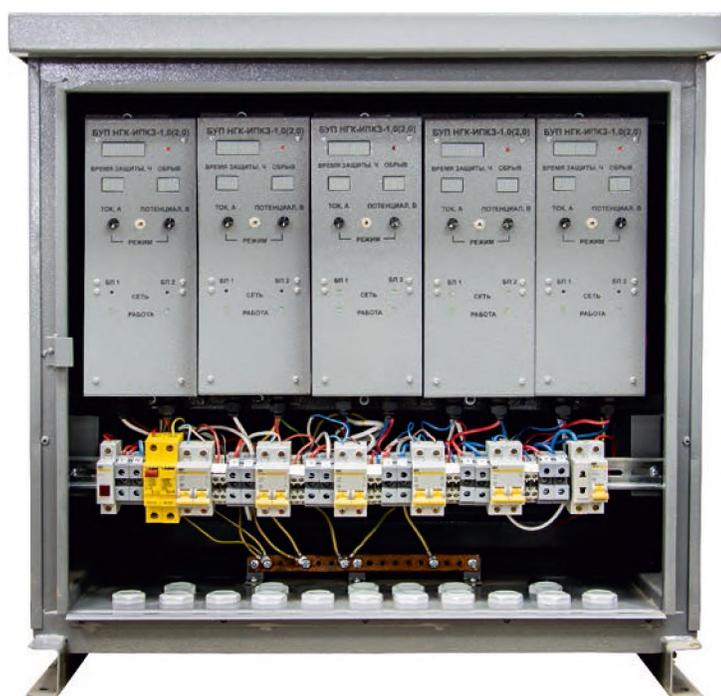
Многоканальная станция катодной защиты НГК-ИПКЗ построена на базе импульсных преобразователей, работающих на отдельные нагрузки, и предназначена для электрохимической защиты наружных поверхностей подземных стальных сооружений от почвенной коррозии.
